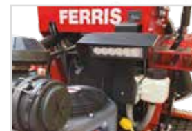
LED tuled - keskipaigaldus Energia tõhus vastupidav keskipaigaldusega 18 W LED tuli.
