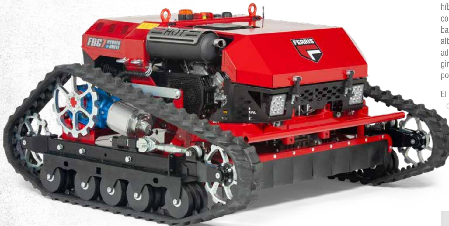
Cortar terraplenes y otras áreas inclinadas puede causar situaciones peligrosas tanto para el operador como a los transeúntes. Usar maquinaria de control remoto reduce el riesgo, el esfuerzo físico y la exposición a vibraciones, ruidos y emisiones. El tren de rodaje de baja gravedad sobre orugas de la segadora FRC7 garantiza la estabilidad en pendientes pronunciadas de hasta 55° y proporciona una tracción superior.
