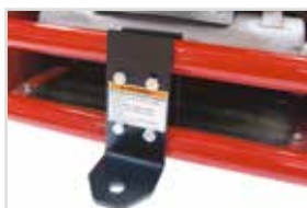
Vonószem 12,7 mm-es furattal rendelkező normál vonószem vontatáshoz.
