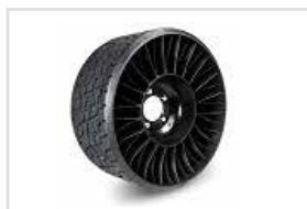
Michelin® Tweel® kerék Jelentősen csökkenti a rázkódást és megszünteti a defektet.
