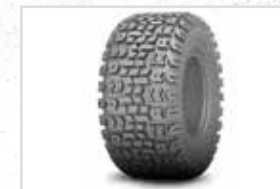
Hátso nagyméretű kerekek A meghajtott kerekek durvább mintázattal rendelkeznek a jobb tapadás érdekében.
