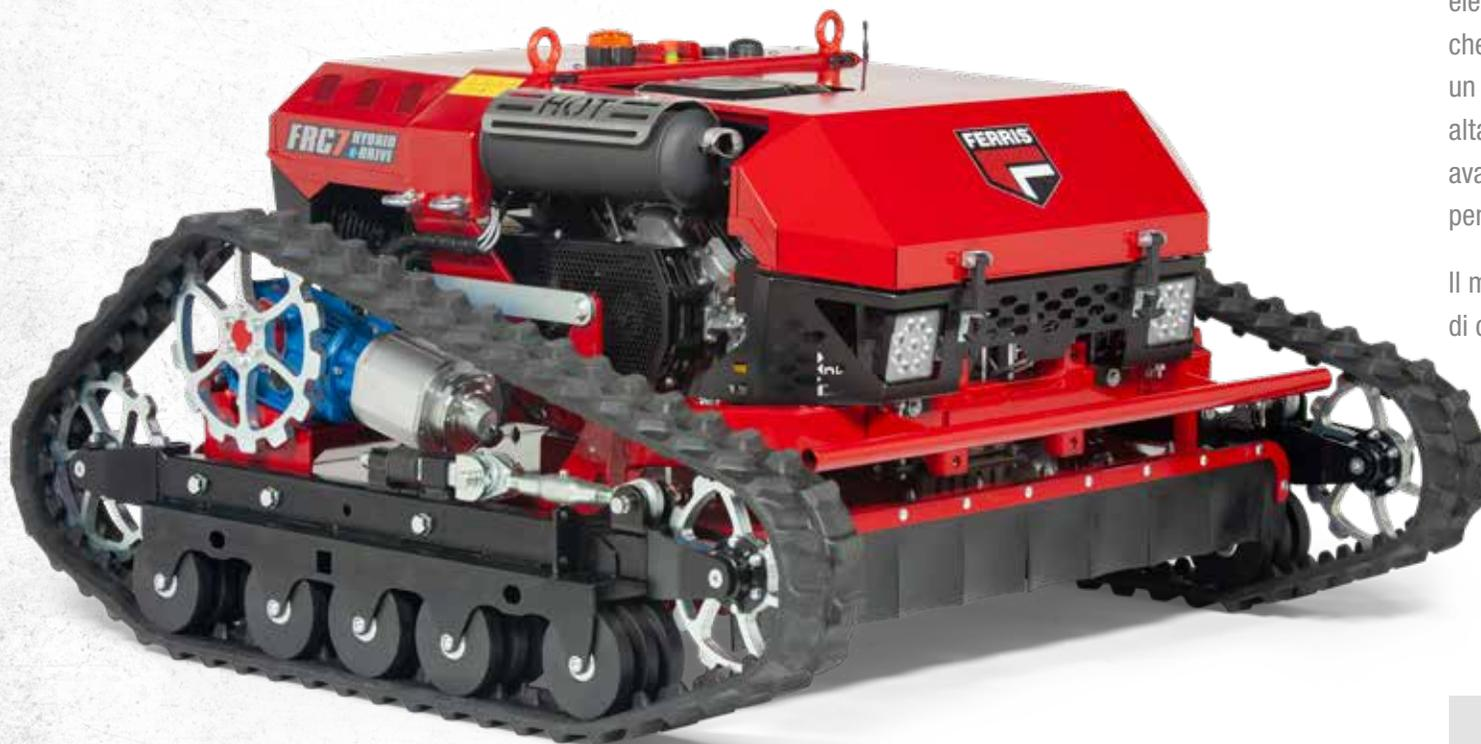
Gli argini e altre aree inclinate possono, potenzialmente, causare situazioni pericolose sia per l'operatore che per i passanti. L'utilizzo di macchinari dedicati con controllo a distanza riduce drasticamente i rischi, lo sforzo fisico e l'esposizione a vibrazioni, rumore ed emissioni. Il telaio cingolato con baricentro basso dell'FRC7 garantisce stabilità su pendii ripidi fino a 55° e offre una trazione superiore.
