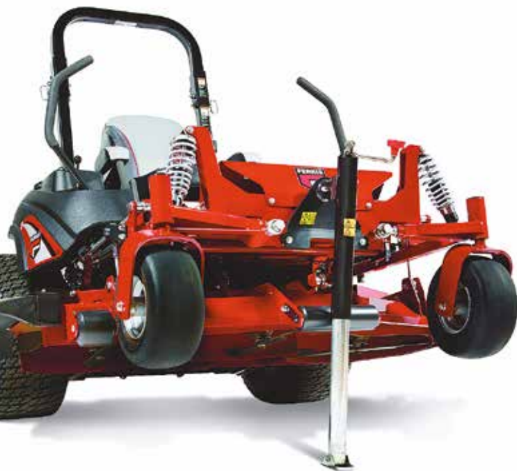
Sada servisního zvedáku Umožňuje snadný přístup při údržbě spodní části záčního ústrojí.
