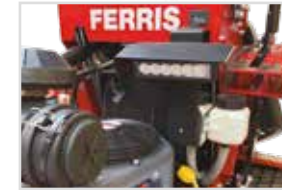
Kit de luz LED - Montaje medio. Luz LED de bajo consumo de 18 vatios montada en la parte media del equipo.
