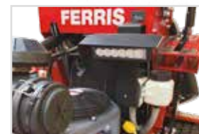
Kit LED svjetala - srednja 18 W srednje montirano, energetski učinkovito LED svjetlo.
