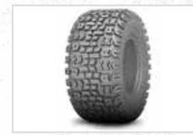
Ruota posteriore tassellata Pneumatico con battistrada più aggressiva per una migliore trazione.
