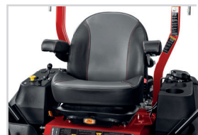
Gefederter Premium-Sitz mit halbhocher Rückenlehne Sitz mit verstellbarer Federung, gepolsterten Armlehnen, nach vorn und hinten verstellbar.
