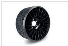
Michelin® Tweel® Verhindert abgefahrene Flanken und platte Reifen.
