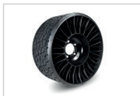
Michelin® Tweel®. Elimina los problemas de desalineación y los neumáticos pinchados.
