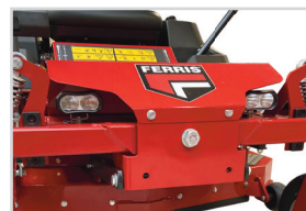
Kit de luz LED - Montaje frontal. 2 luces LED de bajo consumo de 6 vatios montadas en el frente.
