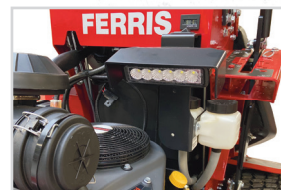
Kit d'éclairage LED - Montage central. Robuste éclairage LED de 18 watt à basse consommation.
