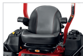
Siège à suspension haut de gamme à dossier mi-haut. Siège réglable haut de gamme avec accoudoirs rembourrés réglables.
