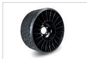
Pneu Michelin X® Tweel® Élimine les talons mal positionnés et les pneus crevés.
