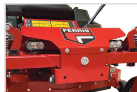
Kit d'éclairage LED - Montage frontal. 2 LED de 6 watt à basse consommation.
